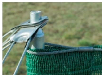
La plaque de retenue du treillis contre le tube porteur, avec bande anti-friction, ainsi que les fixations par vis, placent le dispositif en conformité avec les sévères exigences sécuritaires. Livraison en rouleaux pratiques, montage et démontage rapides, stockage peu encombrant.
